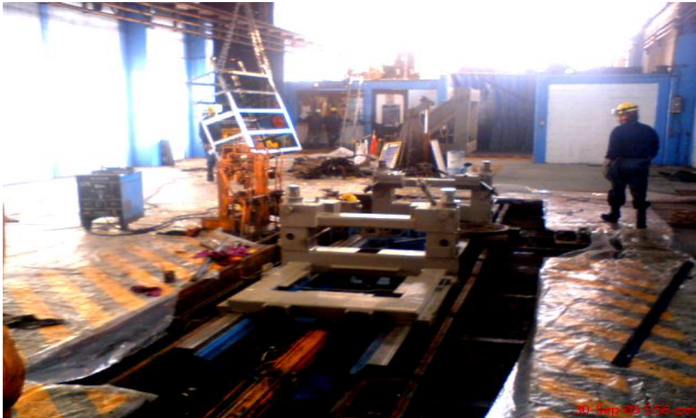
Figura 10. Muestra el esqueleto de la maquinaria donde se visualizan los rieles de nivelación.
