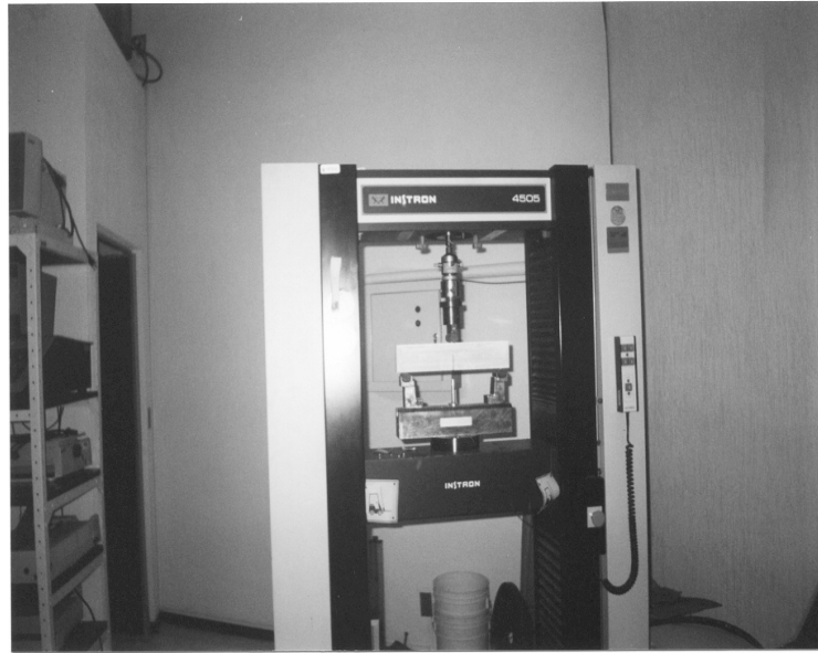
Figura G.5 Máquina Universal de Ensayos Mecánicos, dispositivo para ensayo de flexión en 3 puntos con presencia de muesca.
