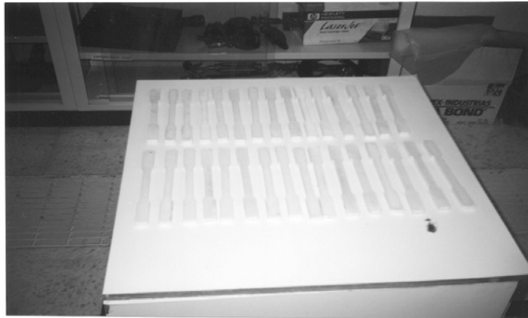
Figura G.2 Piezas resultantes del desmoldeo para el ensayo de tensión. Relaciones agua/polvo 0.28, 0.31 y 0.40
