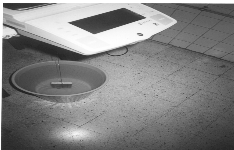
Figura G.11 Determinación real de piezas ensayadas por flexión en 3 puntos con presencia de muesca. Inmersión en agua.
