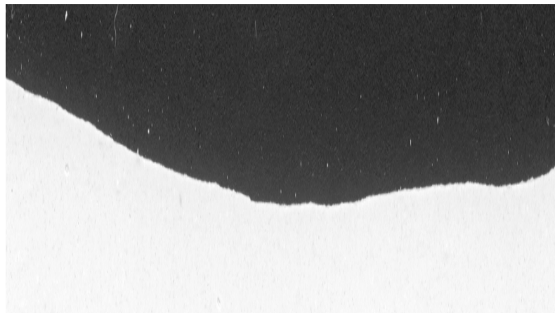
Figura 3.15 Perfil de la zona de fractura digitalizada a 600 pps de una placa de yeso piedra dental con número 82 28 . Relación agua/polvo 0.31.
