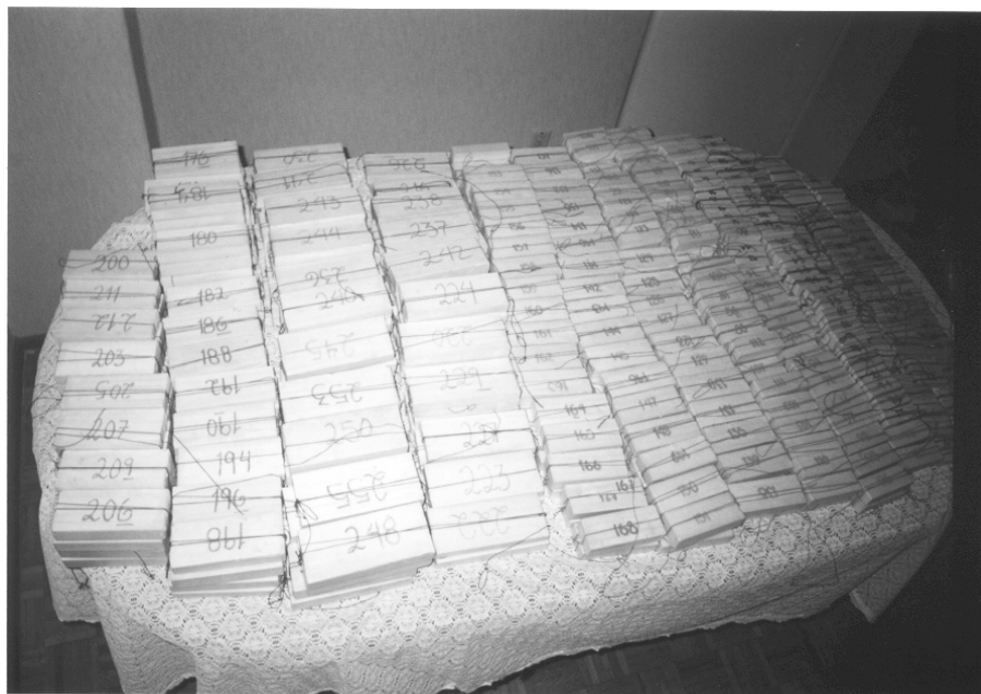
Figura G.10 Clasificación de piezas fracturadas en el ensayo de flexión en 3 puntos con muesca. Cinco diferentes moldes para ensayo de densidad real.
