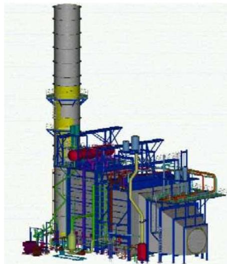
Figura 14. Recuperador de calor
