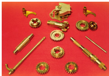
Figura 1.7 Elementos automotores tratados criogénicamente [1.4].
