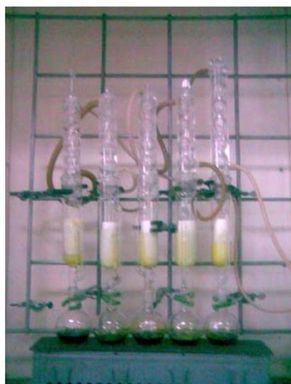
**Figura 9. Extracción de la parte lipídica de las hojas de *Gliricidia sepium* empleando el método de Soxhlet**
