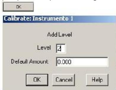
Para el resto de los estándares seguir estos últimos dos pasos y una vez integrando todos los niveles de la tabla con los estándares, seleccionar el tiempo de retención de cada compuesto e ir identificando con el nombre los compuestos, (Metanol, Etanol y Acetona), colocar la concentración correspondiente de cada estándar y en la columna de ref e ISTD seleccionar en todos NO excepto en el isobutanol que es el estándar interno hay seleccionar Yes en ambas columnas
