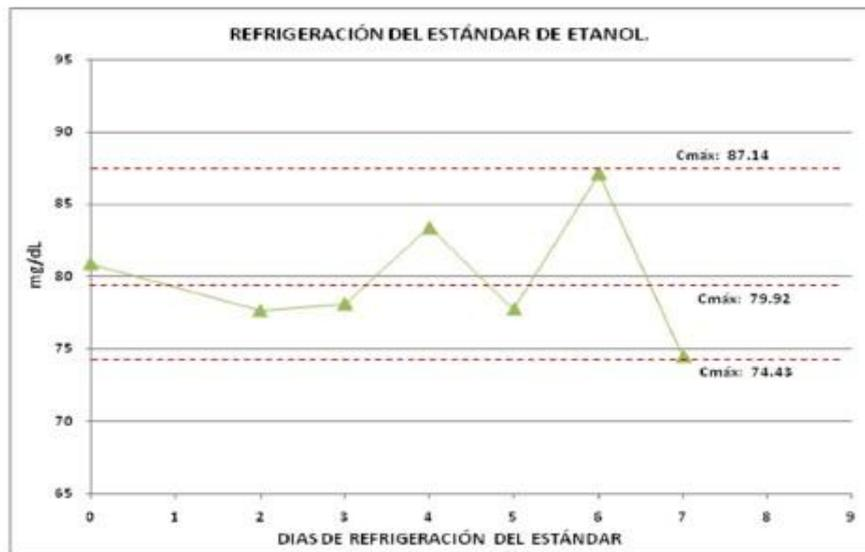
Figura 6.42. Refrigeración Etanol
