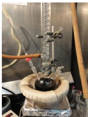
Figura 2.5 Montaje usado para la síntesis de nanopartículas de Co.
