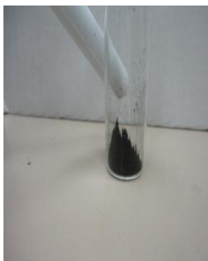
Figura 2. 6 Polvo de nanopartículas metálicas de cobalto. Se aprecian sus propiedades magnéticas.
