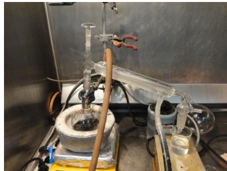
Figura 2.13 Proceso de separación del solvente mediante destilación.
