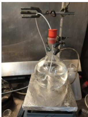
Figura 2. 1 Des-gasificado del Etanol.
