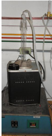
Figura 2. 7 Horno cerámico para tratamientos térmicos.
