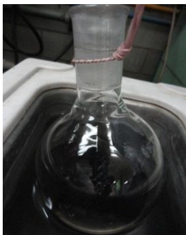
Figura 2.12 Dispersión de los polvos de Co y Carbón Vulcan en 2-Propanol mediante baño de ultrasonido.
