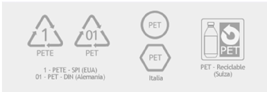
Figura. 1. Sistema de identificación de envases de PET.
