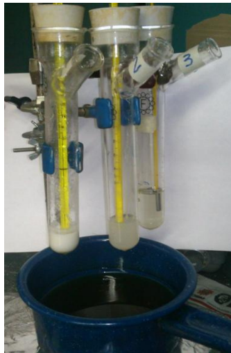
Figura 24: Enfriamiento de la reacción a temperatura ambiente
