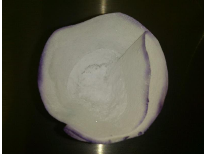
Figura 28: Torta seca después de 72 horas a 60°C (cristales de BHET).
