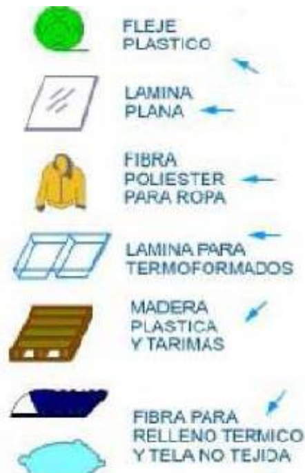
Figura 22. Principales usos del PET reciclado 1 .
