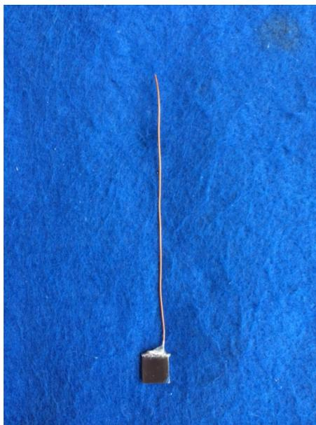
**Figura 3.5 Muestra con el contacto lista para ser sometida a la experimentación con Cargado Catódico.**
