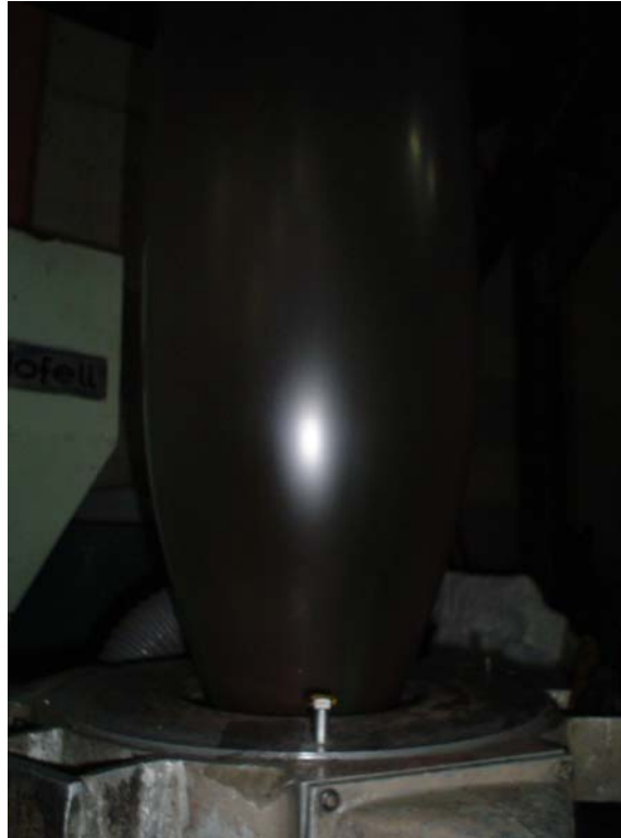
Foto No. 15 Producción de película con PEBD3 Al momento de comenzar a estabilizar la burbuja
