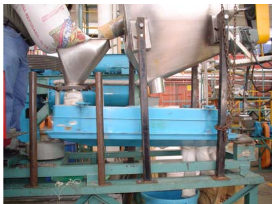
Foto No. 4 Tamizado del compactado
