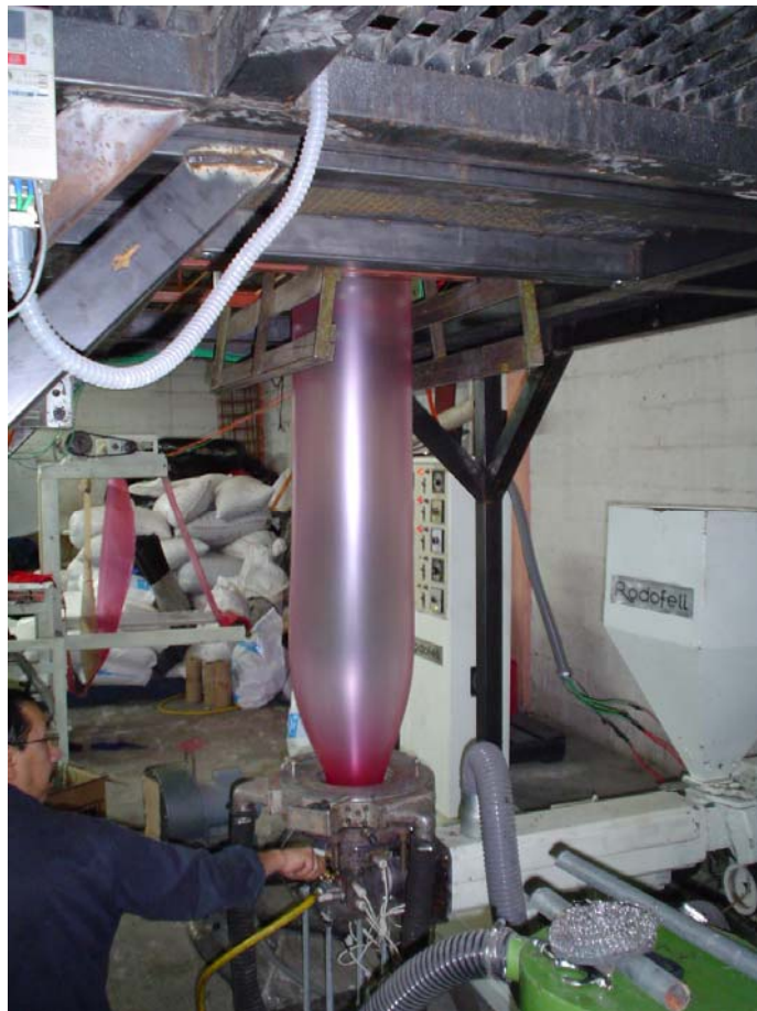
Foto No. 13 Producción de película con PEBD2 al comienzo de estabilizar la burbuja
