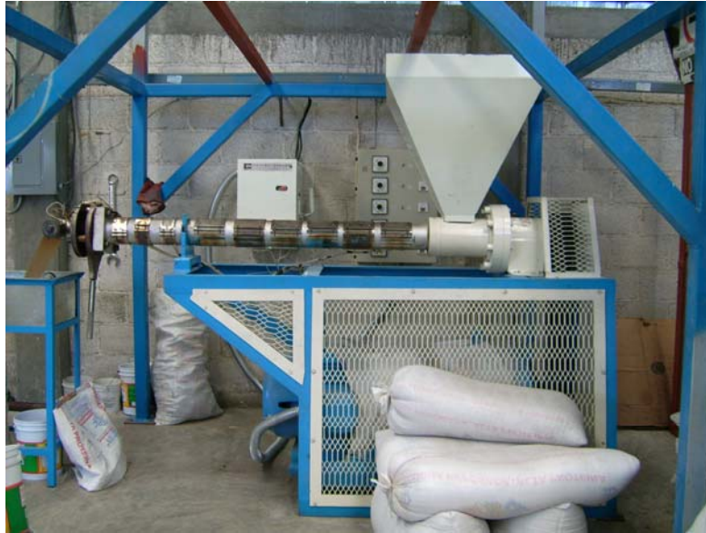
Foto No. 5 Aspecto lateral de la máquina extrusora de pellet
