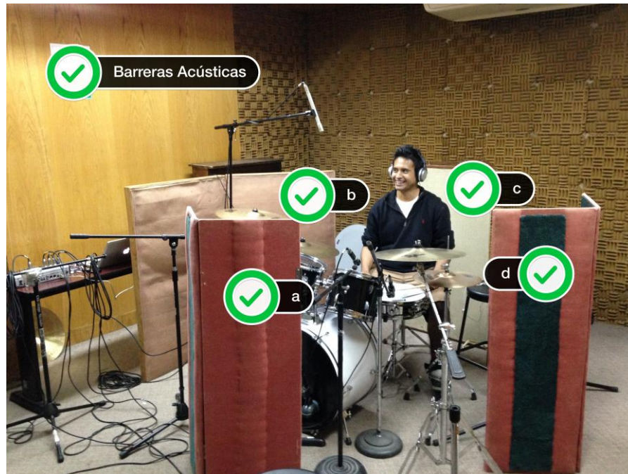
Figura 2.3 Posicionamiento de barreras acústicas antirreflejantes.
