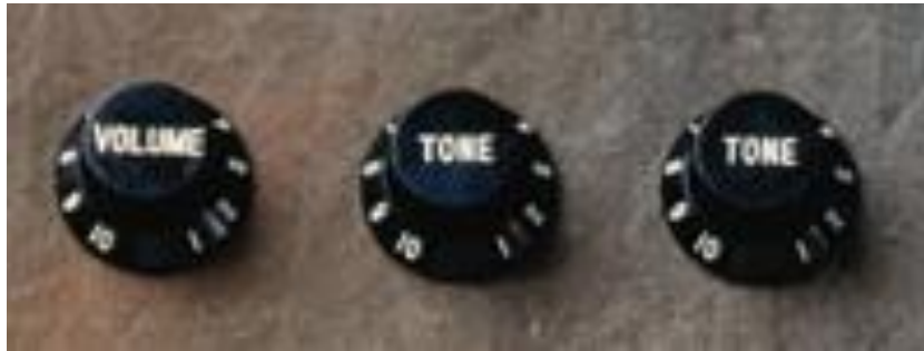
Figura 1.19 Controles de la guitarra eléctrica.
