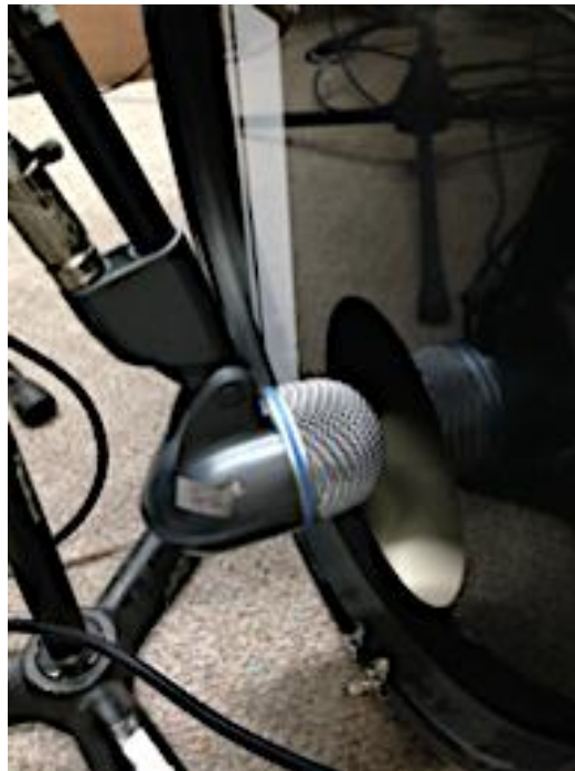
Figura 2.2 Beta 52A captando al bombo.
