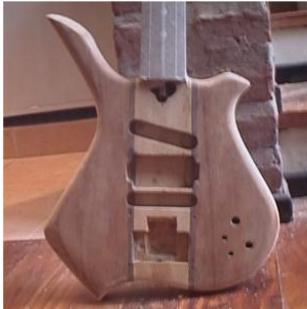
Figura 1.15 Cuerpo convencional de una guitarra eléctrica.
