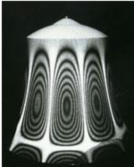
Figura 1.23 Interferogramas Holográficos obtenido mediante haces láser, ilustrando algunos modos de vibración en una campana
