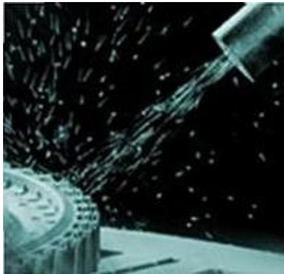
Figura I.11.- Aplicación del granallado a un engrane recto
