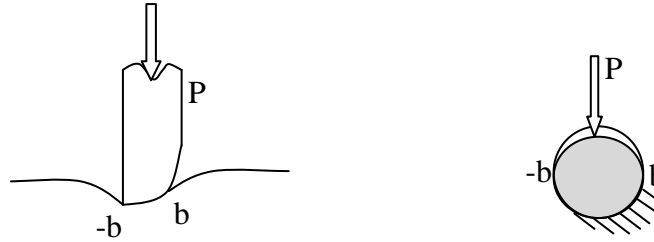
a) Contacto incompleto con Singularidad b) Contacto incompleto y Conformación
