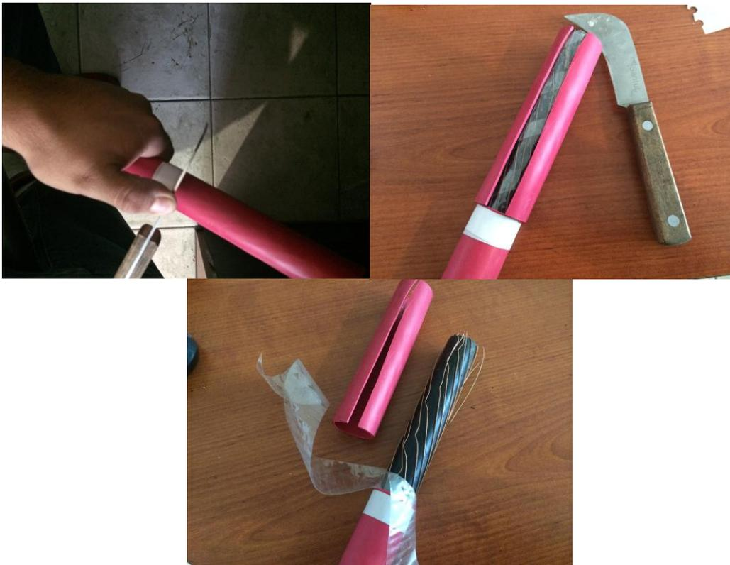
**Figura 28 Método usando cuchillo**
