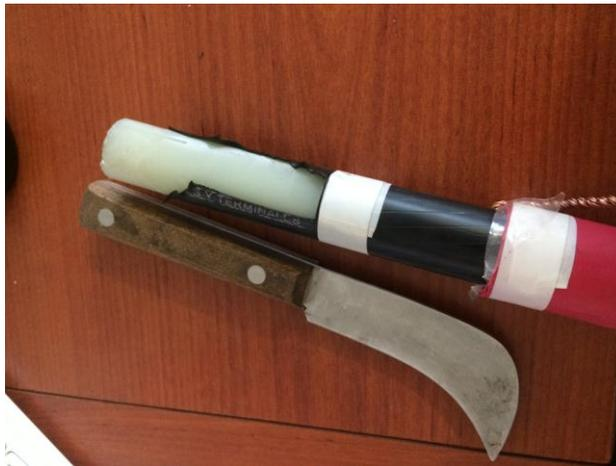
**Figura 31 Retiro de semiconductor sobre el aislamiento**
