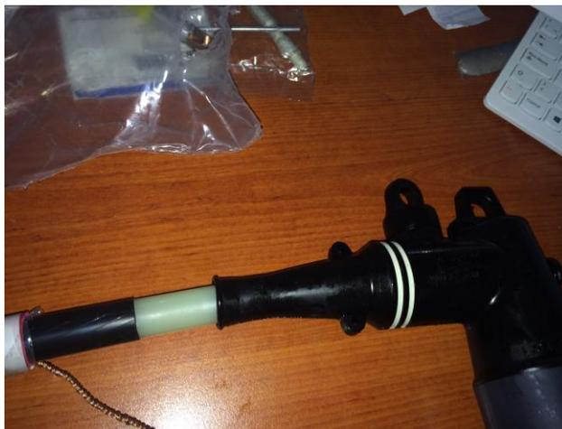
**Figura 25 Codo occ para cable de energía cal. 1/0**
