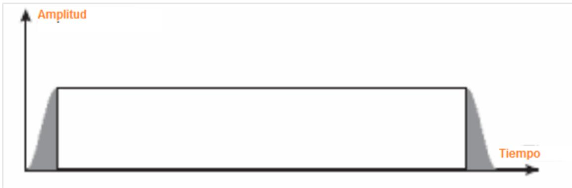
Fig 1.15 Se muestra como un pulso formado a través de coseno alzado a través de las partes sombreadas señalan las extensiones.
