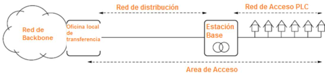
Fig. 1.5 Conexión Backbone
