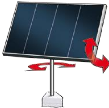
Figura 2.16 Seguidor solar de dos ejes. [7]
