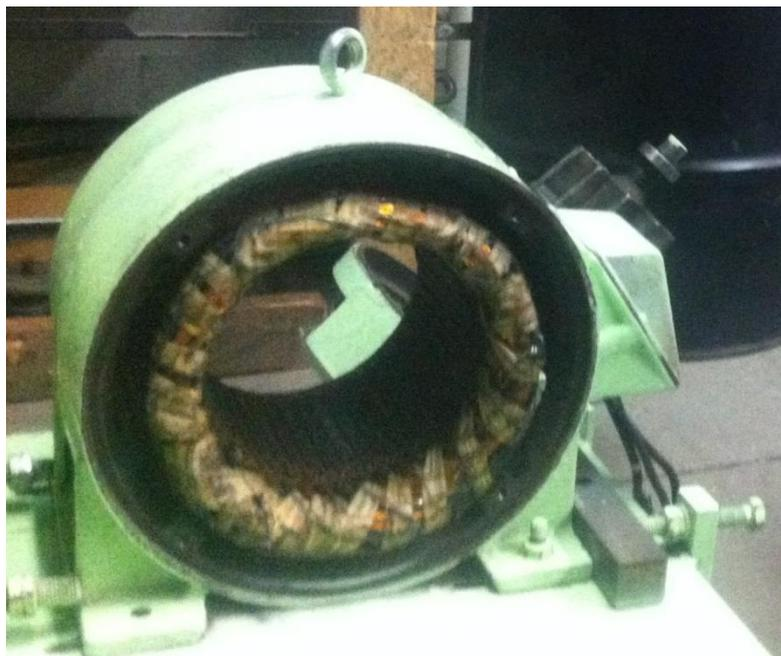
*Ilustración 59. Limpieza con brocha y aire comprimido al estator del motor de 20 HP.*
