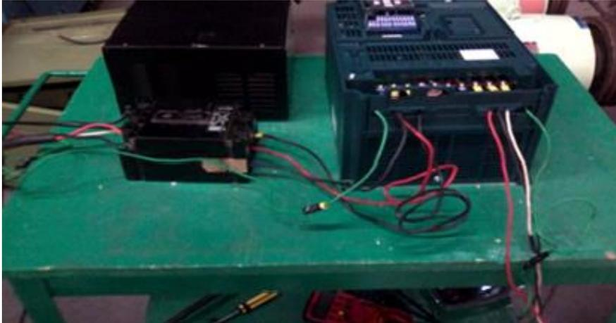
*Ilustración 74. “Drive” utilizado para el control de velocidad en el primo motor del generador síncrono.*
