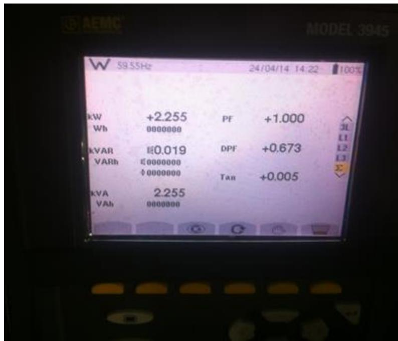
Ilustración 77. KW obtenidos del generador, por medio de un analizador de calidad eléctrica.
