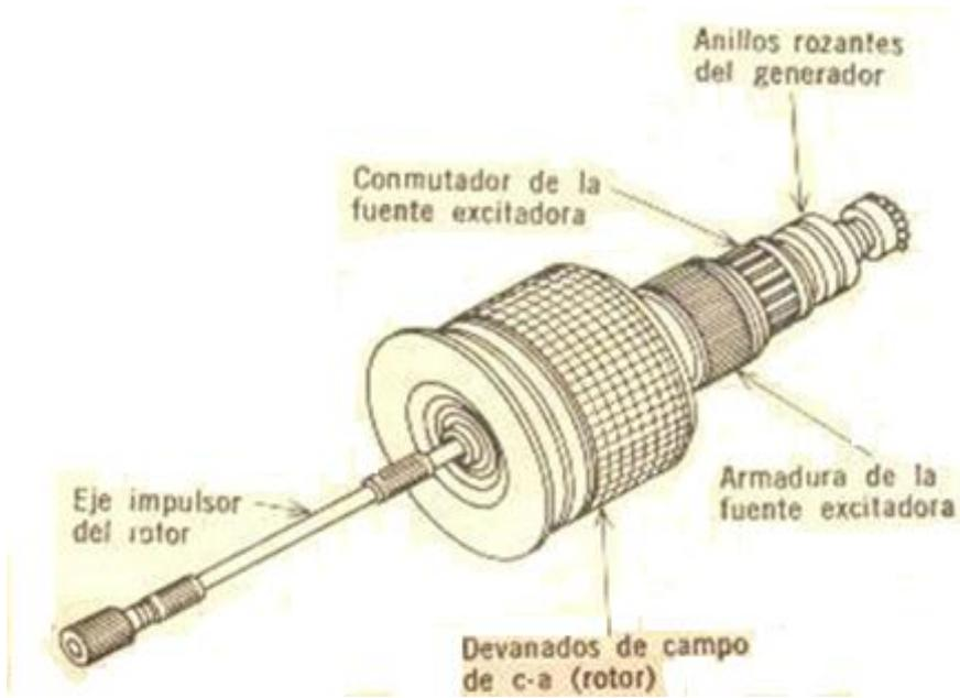
Ilustración 19. Inductor (rotor) de un generador de CA. Fuente [ (Grupo electrógeno, 2014)].
