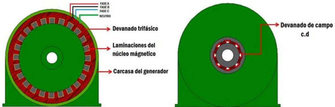
Ilustración 18. Generador de corriente alterna.
