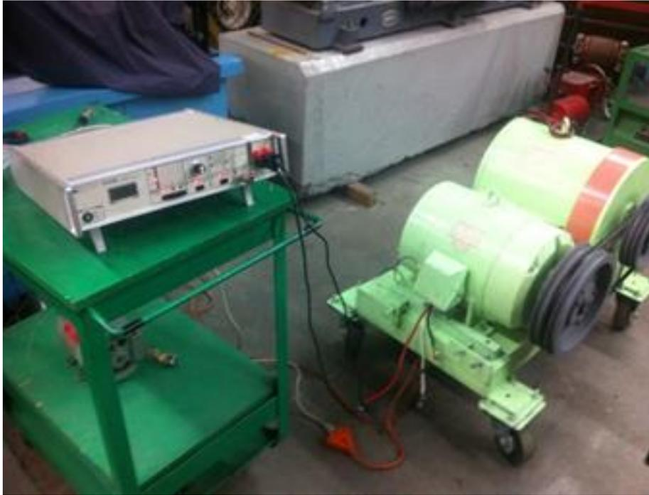
*Ilustración 79. Prueba de resistencia óhmica al motor de inducción (prueba de entrega).*
