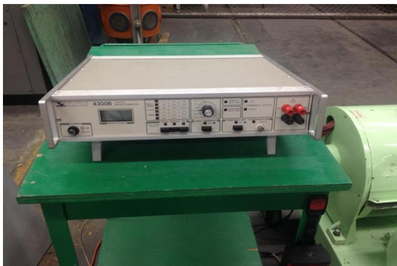
Ilustración 34. Puente con el que se midió la resistencia óhmica de los devanados [Manual. DIGITAL MICRO - OHMMETER 4300B, 2014].
