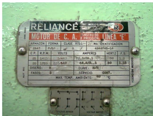
Ilustración 21. Placa de características del motor de 20 HP.
