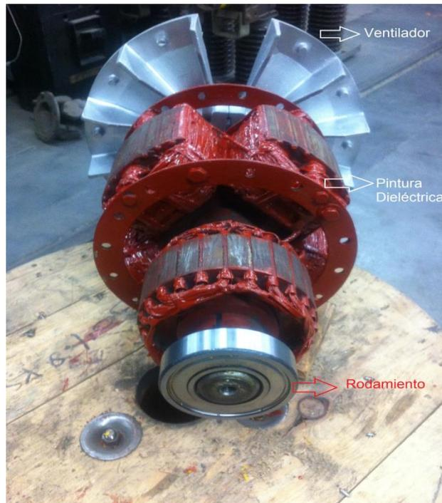
*Ilustración 58. Rotor del generador síncrono, con la aplicación de pintura y de valeros nuevos.*
