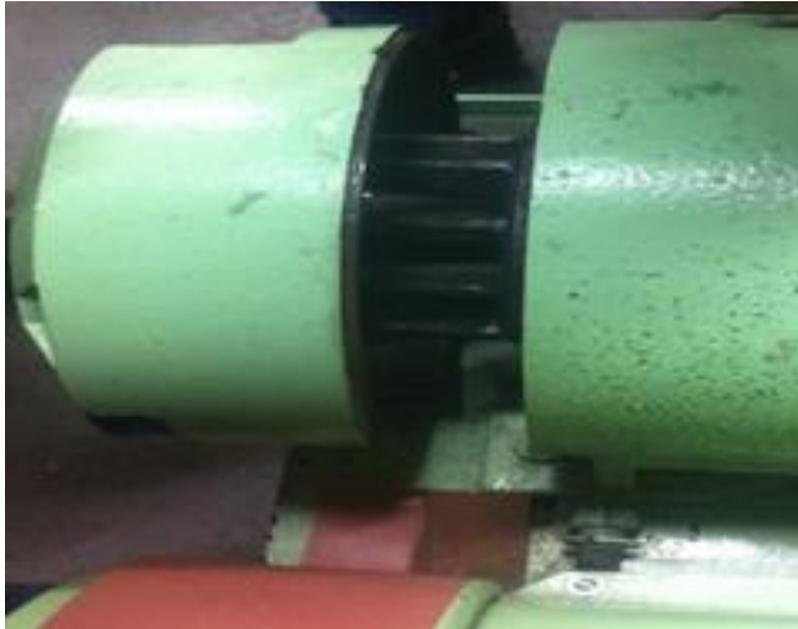
*Ilustración 61. Retirando la tapa del motor de 20 HP.*
