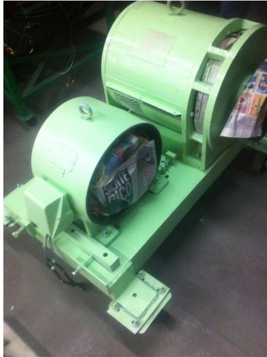
*Ilustración 63. Aplicación de la pintura al motor de 20HP, por medio de pintura en aéreo sol.*
