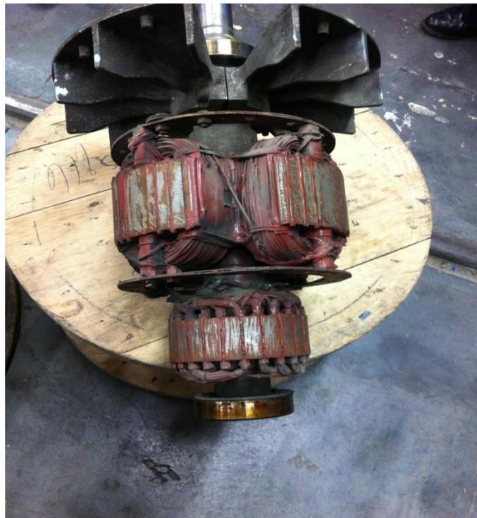
*Ilustración 56. Extracción del rotor del generador síncrono.*
