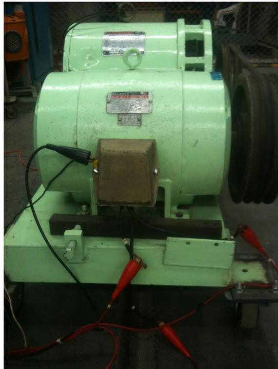
Ilustración 48. Conexiones del equipo de prueba al motor de inducción para la realización del ensayo.
