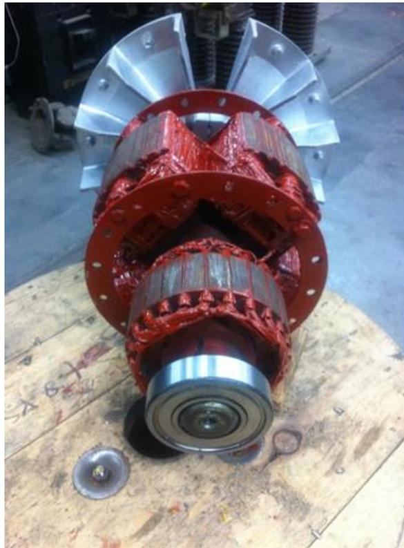
*Ilustración 9. Excitatriz de diodos giratorios colocados en la flecha.*
