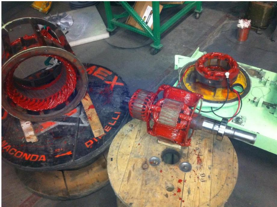
*Ilustración 57. Aplicación de pintura dieléctrica al generador síncrono.*
