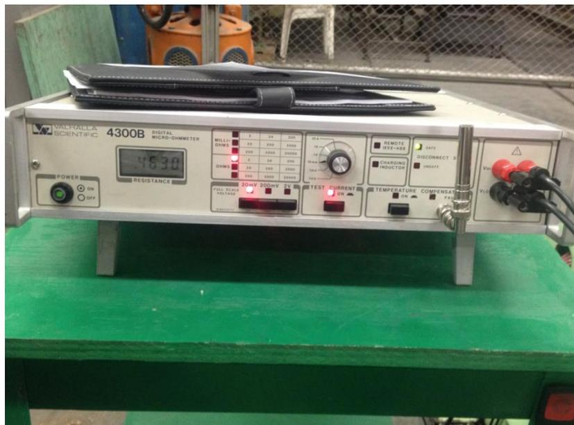
*Ilustración 36. Valor obtenido de la resistencia de los devanados "A" y "B" (sin compensador de temperatura).*
