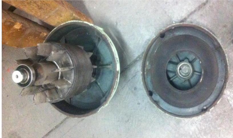
*Ilustración 60. Limpieza al rotor del motor de 20HP.*
