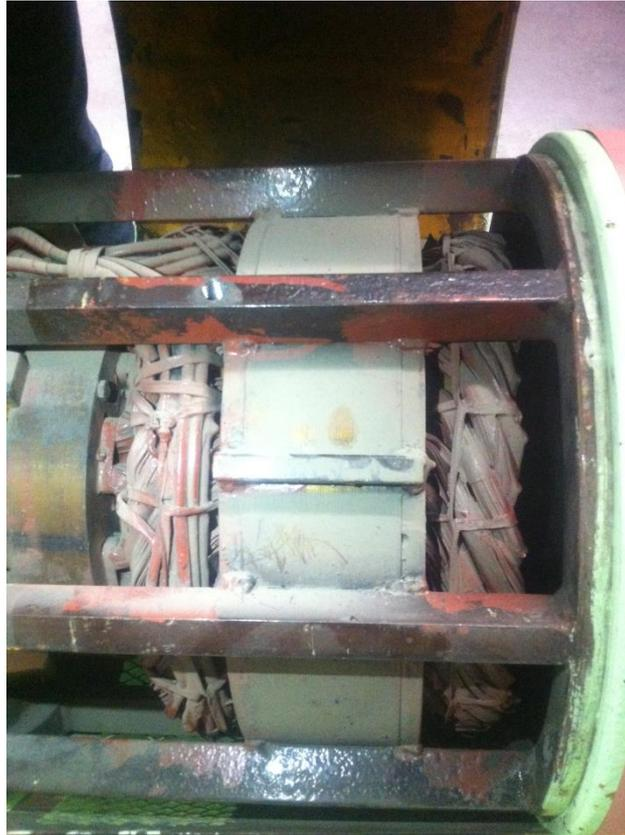
*Ilustración 23. Interior del generador que se encuentra cubierto por una capa de polvo.*
