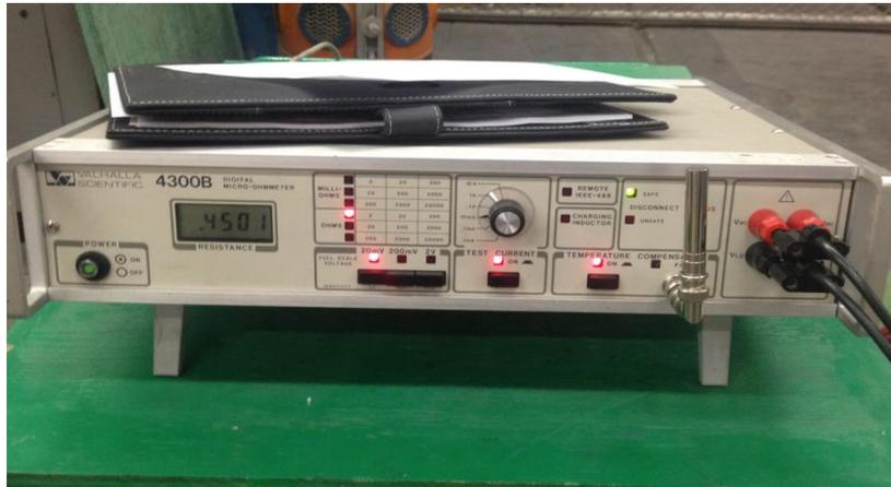
*Ilustración 37. Valor obtenido de la resistencia de los devanados “B” y “C”, (corregido a una temperatura de  $19^\circ\text{C}$ ).*
