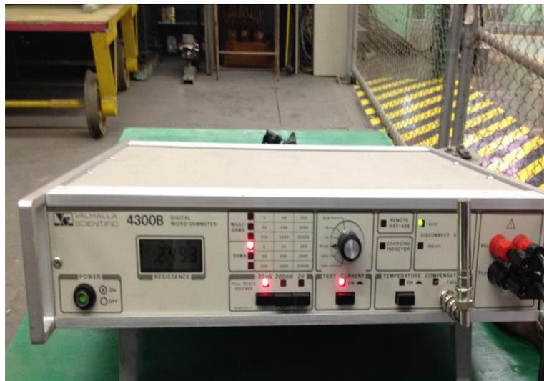
Ilustración 39. Valor obtenido de la resistencia óhmica del generador, de la fase “B” y neutro.
