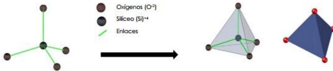
Figura 2. Esquema de la disposición espacial de los cationes y aniones en silicatos
