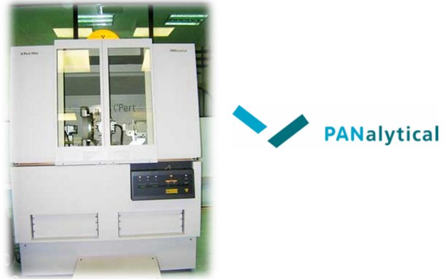
**Figura 9.** Difractómetro X'PERT Pro MRD PANalytical.
