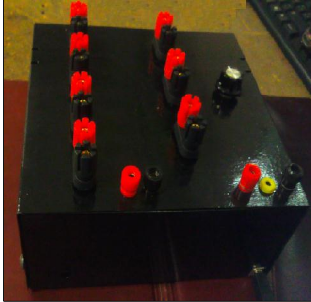
Imagen 4.16 Gabinete con sus terminales de medición y su puerto de comunicación.
