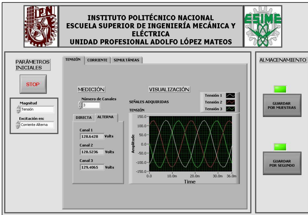
Imagen 4.2 Medición de Tensión en C.A. de Fase a Tierra con Tres Canales.
