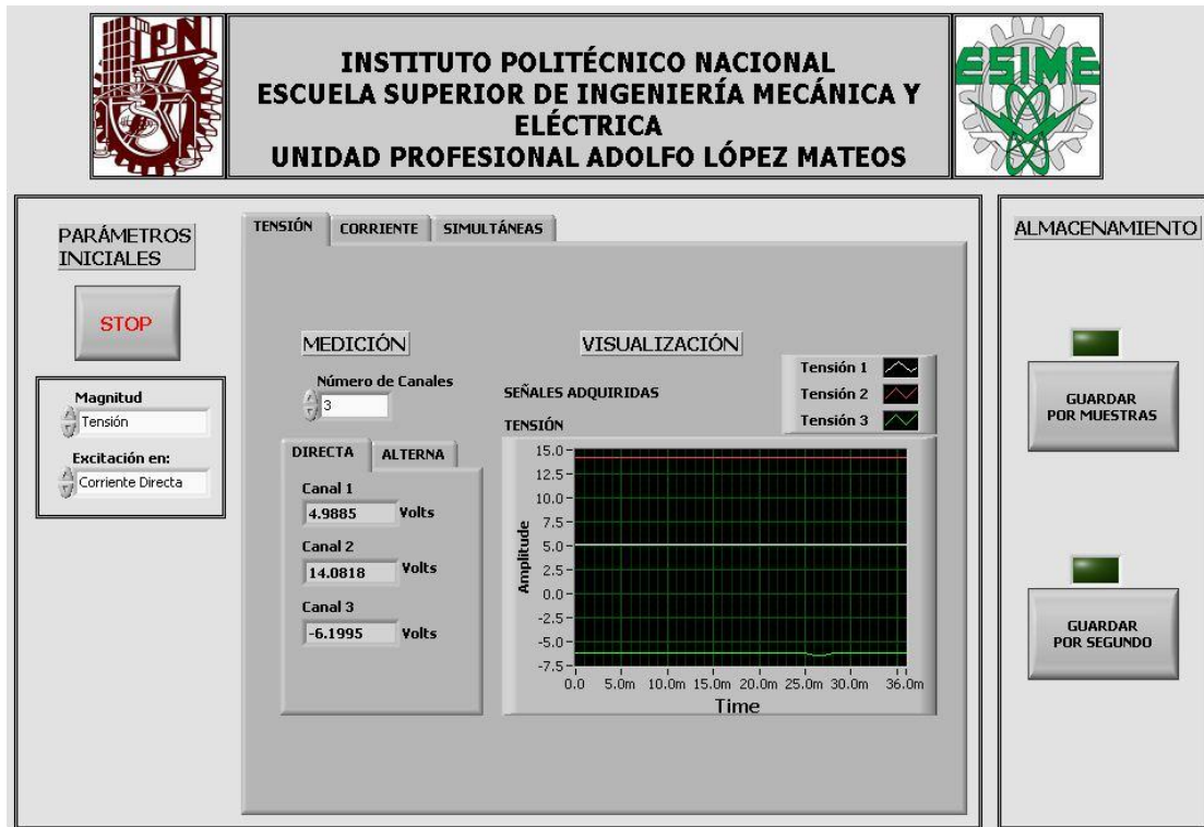
Imagen 4.1 Medición de Tensión en C.D. con Tres Canales.
