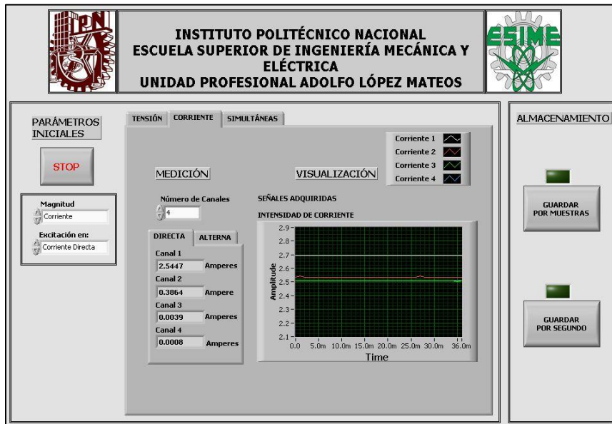
Imagen 4.4 Medición de Corriente en C.D. con Cuatro Canales.
