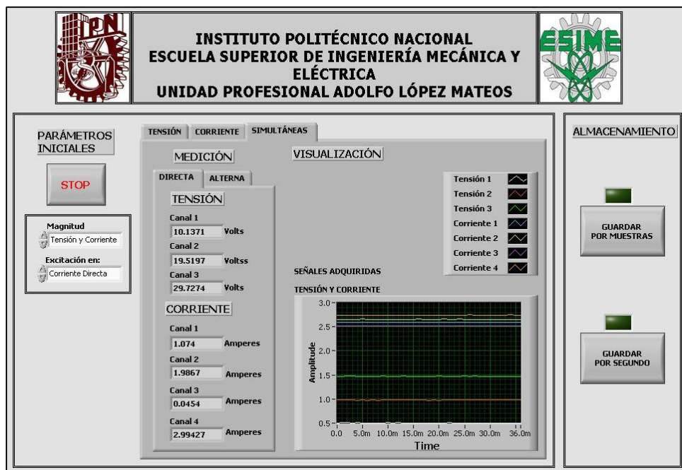
Imagen 4. 20 Panel Frontal de Medición simultánea de Tensión y Corriente en C.D.
