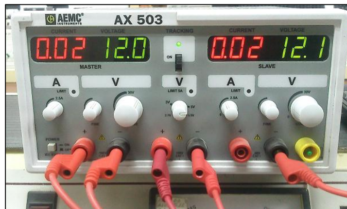
Imagen 4.17 Arreglo de fuente de corriente directa para la alimentación de los transductores
