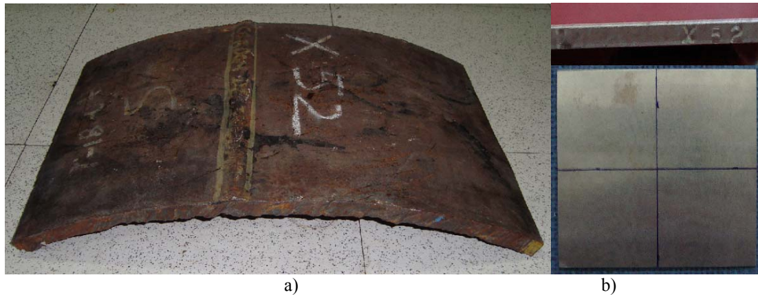
Figura 2.14: Fotos de a) Sección retirada de un ducto de transporte de hidrocarburos de PEMEX Región Sur y b) Muestra maquinada de los aceros API-5L, con una marca que identifica el tipo de acero y la dirección del eje longitudinal (L) del acero.
