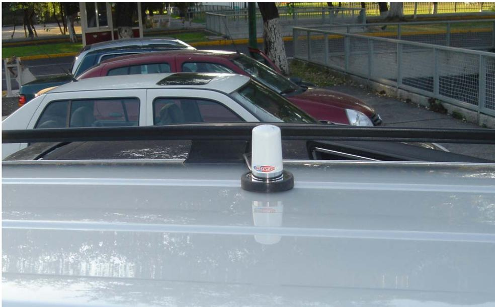
Figura 19. Antena colocada sobre el vehículo como parte del VMM 6300
