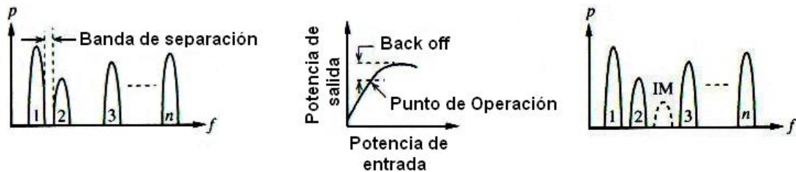
Figura 3.2 Señales de acceso múltiple a la entrada y a la salida del repetidor en un sistema real P es la potencia, f es la frecuencia de las señales e IM es la intermodulación.
