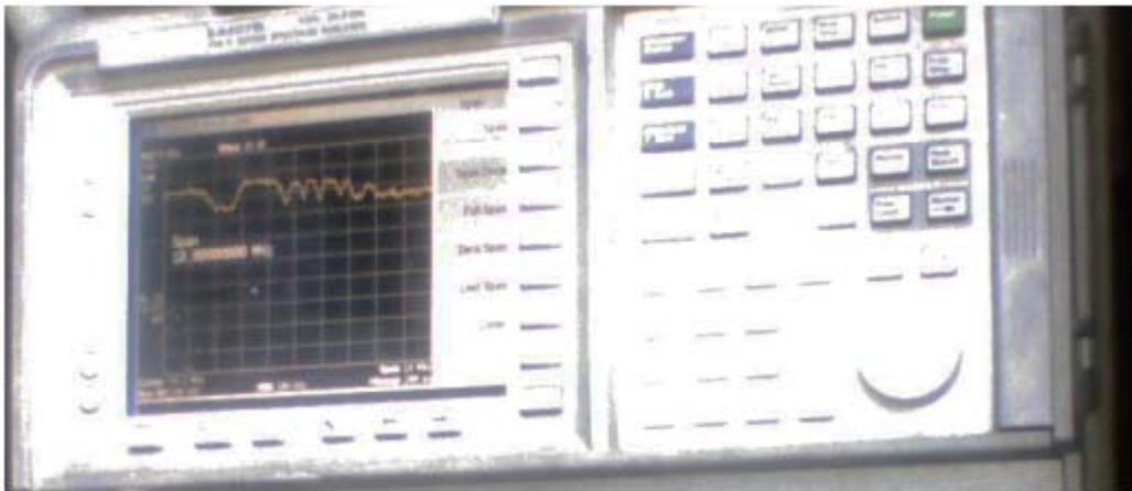
Fig. I.7 Calibración del ancho de banda para transmisión.
