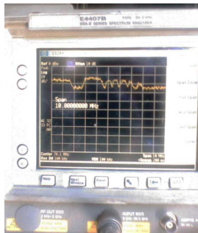
Fig. I.8 Portadora de 2 MHz y portadoras adyacentes.
