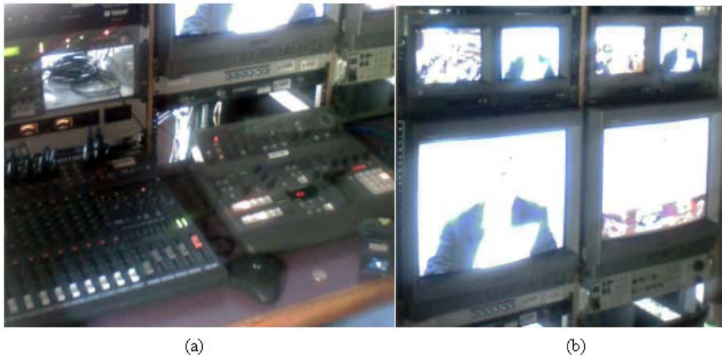
Fig. I.2 Estudio de Televisión. a) Mezcladora de audio, control de cámaras y control de señal de video compuesto, b) Monitores de video.
