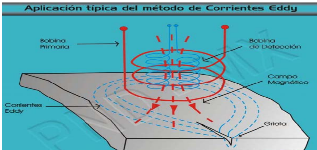
Figura J5. Corriente parasita.
