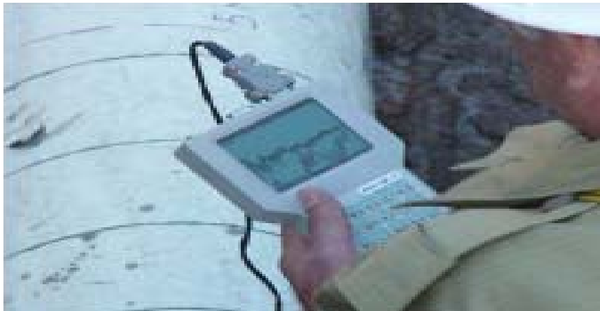
Figura J2. Inspección de partículas magnéticas. (ASM, 1998).
