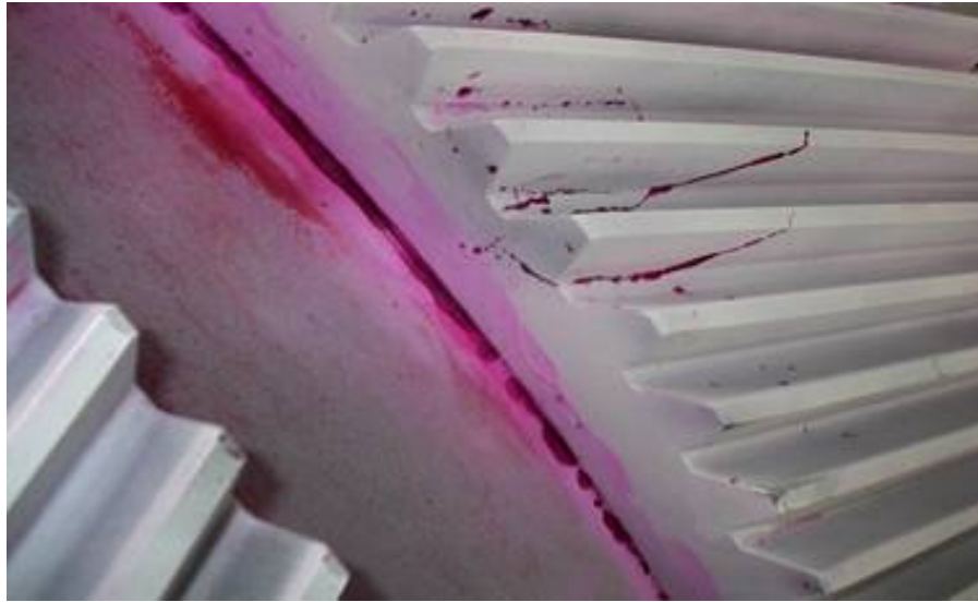
Figura J1. Ensayo por líquidos penetrante.
