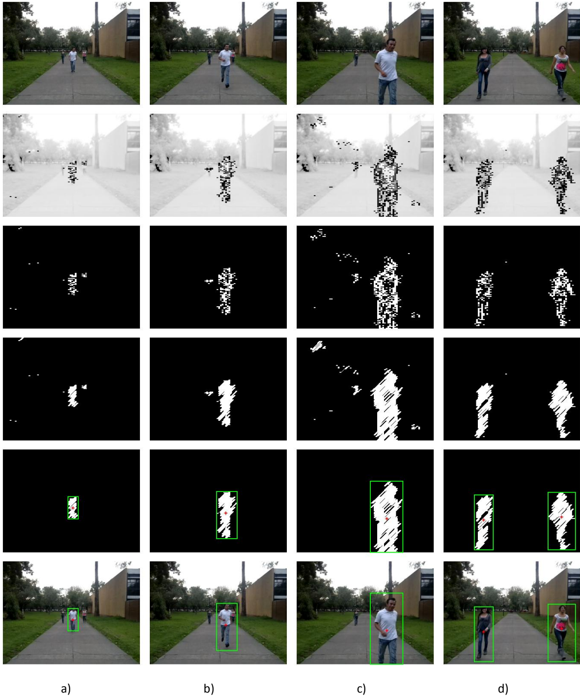
Figura 4. 6 Resultados del Algoritmo D aplicado a la secuencia de video "Alumnos_3", de arriba abajo, Trama actual en espacio RGB, modificación del contraste en ventanas consideradas como movimiento, imagen binaria de ventanas consideradas movimiento, aplicación de la operación morfológica de cerradura, aplicación del umbral de área máxima, enmarcado y centroide del objeto en la trama actual en espacio RGB. a) Trama 285, b) Trama 310, c) Trama 330, d) Trama 510.
