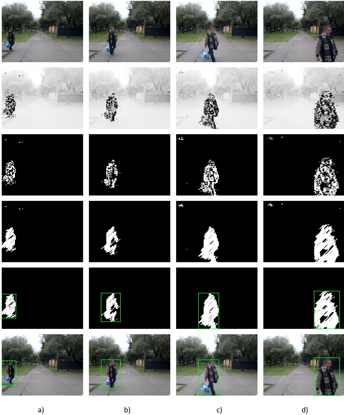
Figura 4. 4 Resultados del Algoritmo D aplicado a la secuencia de video "Profesor_exterior", de arriba abajo, Trama actual en espacio RGB, modificación del contraste en ventanas consideradas como movimiento, imagen binaria de ventanas consideradas movimiento, aplicación de la operación morfológica de cerradura, aplicación del umbral de área máxima, enmarcado y centroide del objeto en la trama actual en espacio RGB. a) Trama 67, b) Trama 98, c) Trama 121, d) Trama 151.
