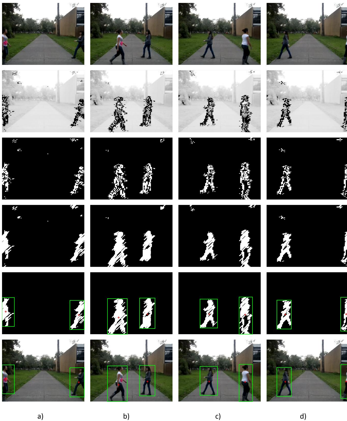
Figura 4. 5 Resultados del Algoritmo D aplicado a la secuencia de video "Alumnas_2", de arriba abajo, Trama actual en espacio RGB, modificación del contraste en ventanas consideradas como movimiento, imagen binaria de ventanas consideradas movimiento, aplicación de la operación morfológica de cerradura, aplicación del umbral de área máxima, enmarcado y centroide del objeto en la trama actual en espacio RGB. a) Trama 113, b) Trama 139, c) Trama 176, d) Trama 193.
