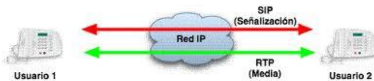
Figura 2-8 Esquema de protocolo SIP.
