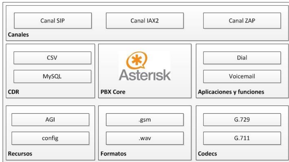
Figura 2.10 Diseño modular de Asterisk.
