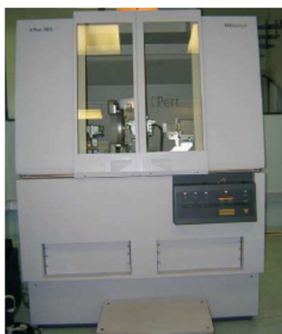
Figura 2.4. Difractómetro X'PERT Pro MRD PANalytical, equipo empleado en la técnica de difracción de rayos X.
