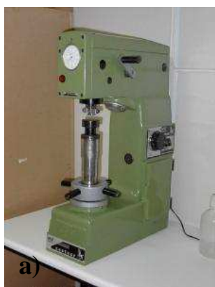
Figura 3.6. a) durómetro Albert b) indentaciones Rocwell C realizadas en probeta borurada 950^\circ\text{C} 6 h de tratamiento.
