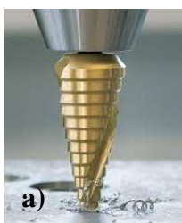
Figura 1.1. Aplicaciones de recubrimientos duros en herramientas de corte, a) broca cónica con recubrimiento TiN, b) discos de corte borurados para el procesamiento del tabaco.
