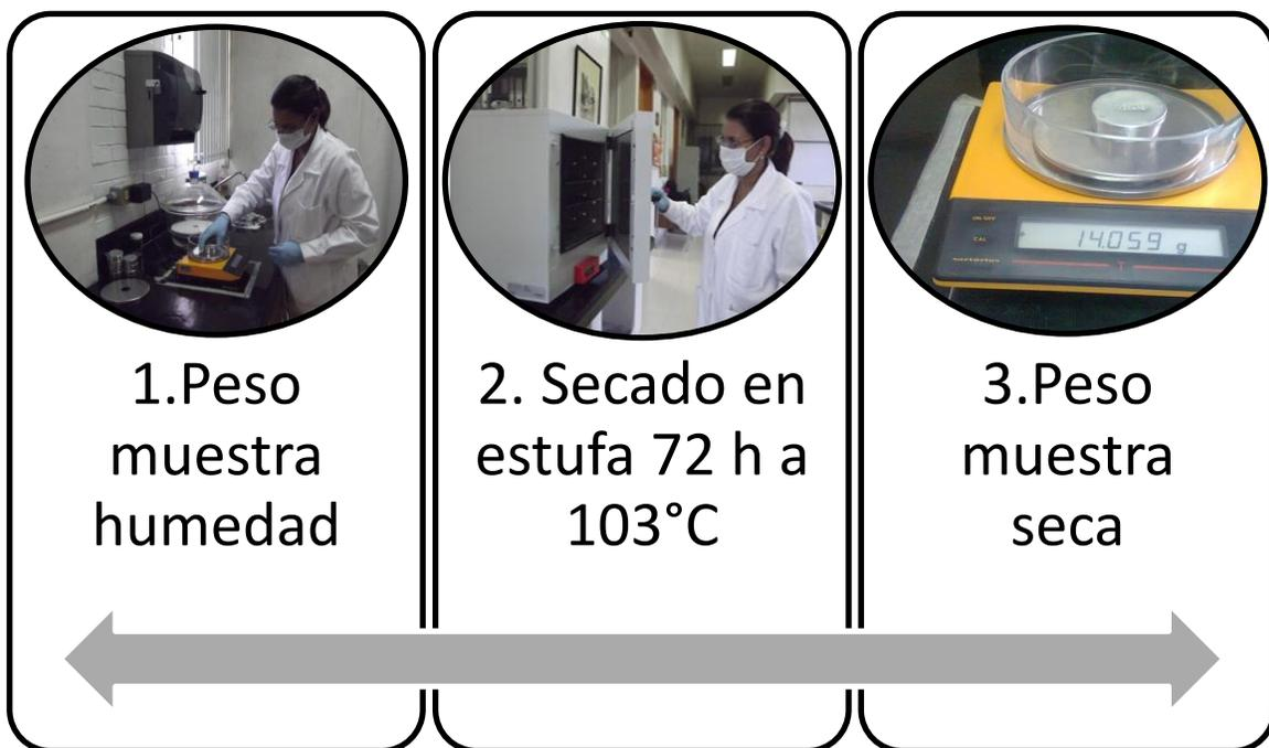
*Figura H.1.* Proceso prueba de humedad (Elaboración propia, 2012)
