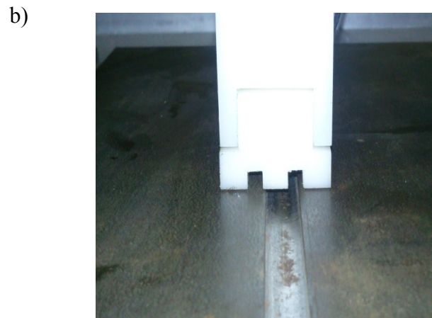
Figura 4. a) Cabezal de sonda MFL-R. b) Sonda MFL-R.
