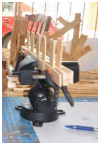
Figura 81. Uso de herramientas especiales (tornillo de banco) para la unión de secciones
