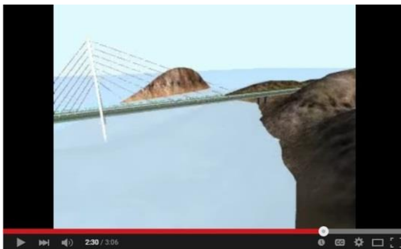
Figura 19a. Puente atirantado o de tirantes
