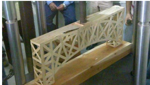
Figura 31c. Aplicación de carga puntual a la estructura
