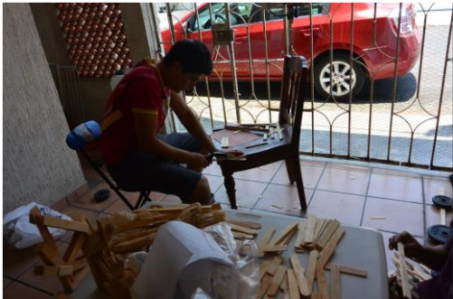
Figura 77. Realización de cortes de elementos de madera tipo abate lenguas
