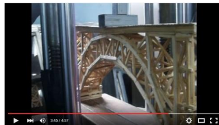
Figura 38b. Aplicación de carga puntual para su prueba física
