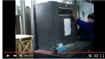
Figura 38d. Registro de carga de falla de la estructura
