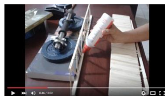
Figura 37d. Procedimiento constructivo 4. Aplicación de adhesivo
