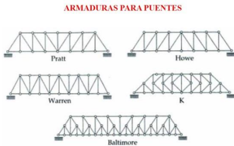
Figura 34a. Prototipos de armadura simple para puentes estandarizados con base en la experiencia
