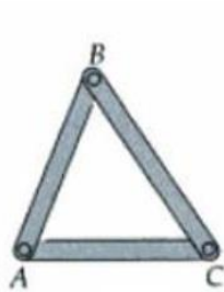
Figura 33a. Armadura triangular rígida
