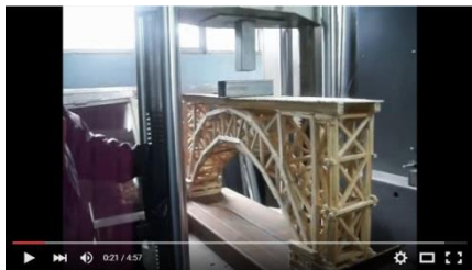
Figura 38a. Colocación del modelo en la prensa hidráulica para su prueba
