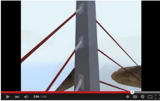
Figura 19b. Cables anclados a las torres
