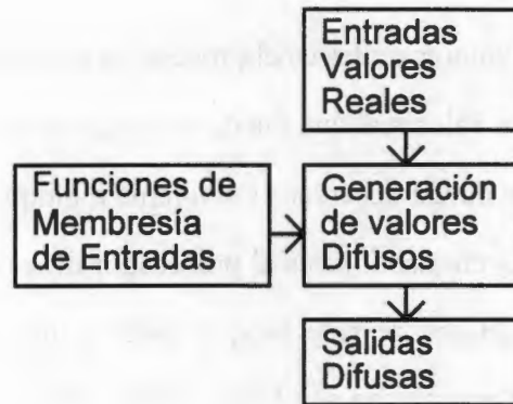
Figura 2.9. Diagrama a bloques del proceso de Generación de los valores difusos.
