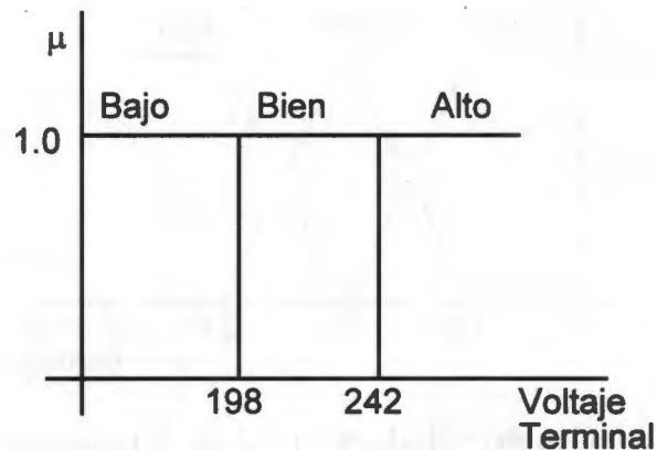
Figura 2.1. Representación del voltaje terminal con lógica Booleana.
