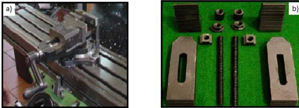
Figura II.12.- Mecanismos de sujeción en la fresadora directamente sobre la mesa. a) Prensa. b) Juego de bridas.
