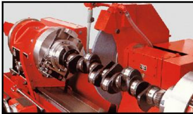
Figura II.9.- Rectificadora de metales.
