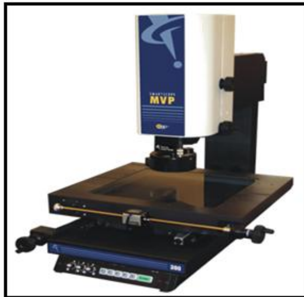
Figura III.15.- Equipo de medición óptico para la verificación de posiciones y diámetros
