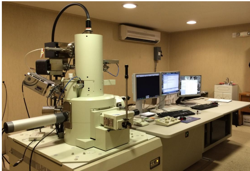
Figura 15. Microscopio electrónico de barrido de alta resolución marca JEOL modelo JSM-6700F.
