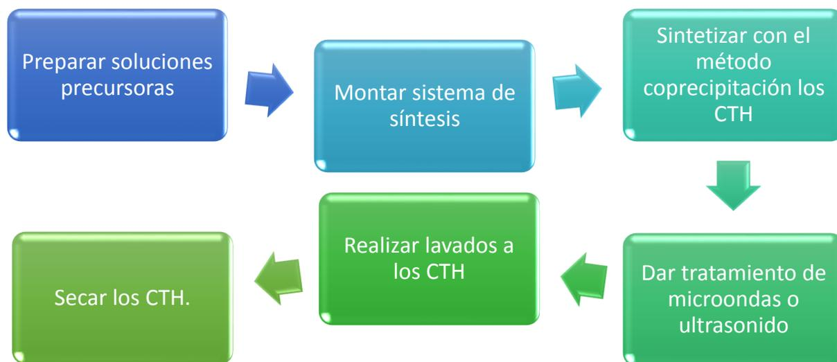
**Figura II.1.** Diagrama de bloques del método coprecipitación para la síntesis de CTH.
