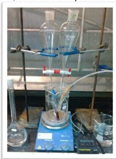
**Figura II.2.** Sistema de síntesis para los CTH
