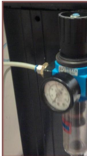
**Figura 4.1.1** Unidad de mantenimiento para la alimentación neumática
