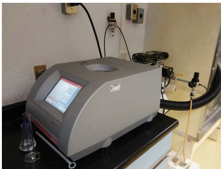
Figura 3.2 Reactor mono modal de microondas Monowave 300 de la marca Anton Paar.
