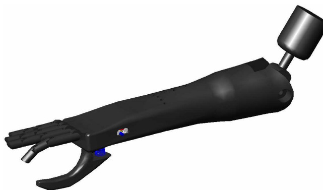
Figura 5.12 Módulo de mano y antebrazo ensamblados mostrando el módulo de flexión
