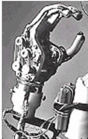
Figura 1.5 mano artificial construida con sensores de presión y temperatura que retroalimentan el sistema de control en la sujeción de objetos.
