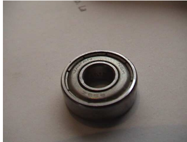
Figura 3.6. Rodamientos acoplados para el sistema de flexión y extensión dentro del módulo mecánico
