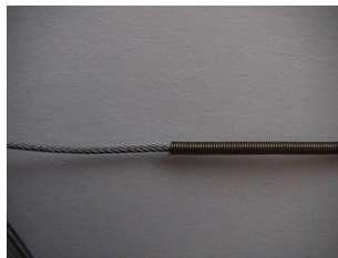
Figura 3.8 Guías para disminuir la fricción de los tendones de Nylon acopladas en el módulo mecánico de flexo-extensión de aluminio
