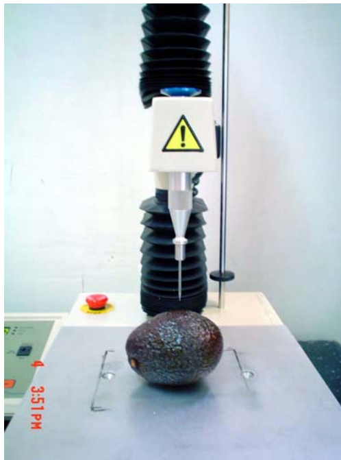
Figura 6. Celda utilizada para la medición de la firmeza de pulpa
