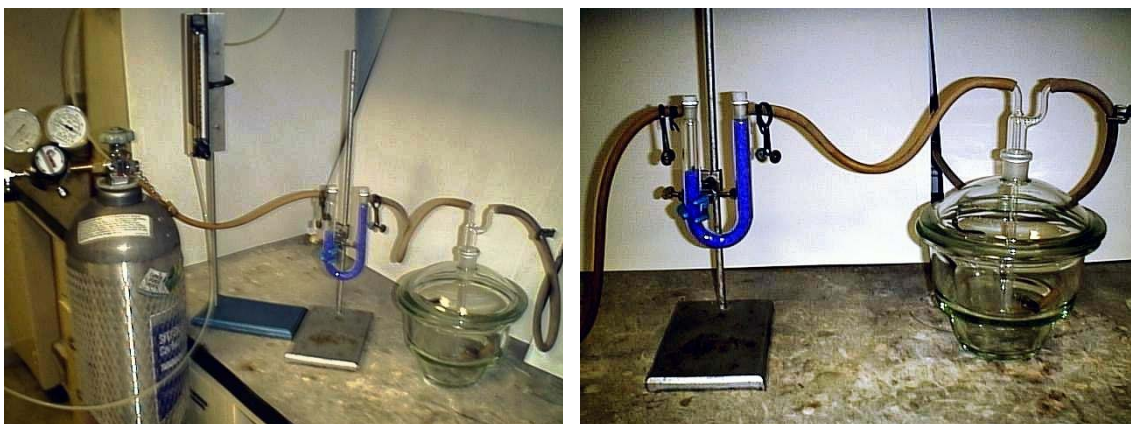
Figura 4. Sistema diseñado para la determinación de la permeabilidad al CO 2 de las películas
