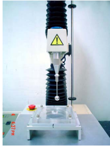
Figura 2. Celda cilíndrica utilizada para las pruebas mecánicas
