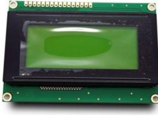
Fig. 4.12. Pantalla LCD de 16x4
