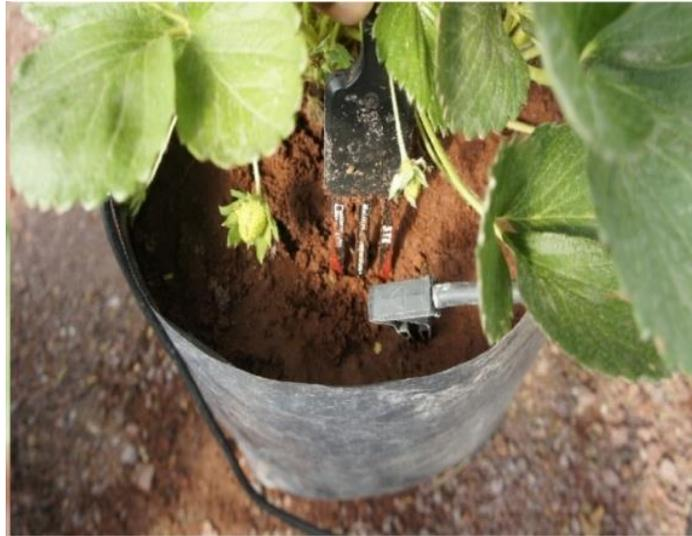
Fig. 4.40. Sensor 5TE colocado a 5cm del gotero.
