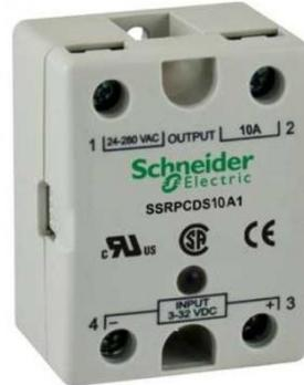
Fig. 4.16. Relevador de estado sólido, voltaje de control de 3 VCD-32 VCD, Voltaje de Carga 24 VCA-240 VCA, Corriente de Carga 10 A.
