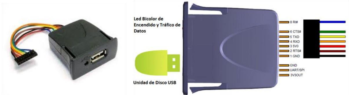
Fig. 4.14. A) Imagen del VDrive2 B) Pines de conexión de los cuales solo se ocupa el Tx y Rx para comunicación asíncrona en modo *Full Duplex*.
