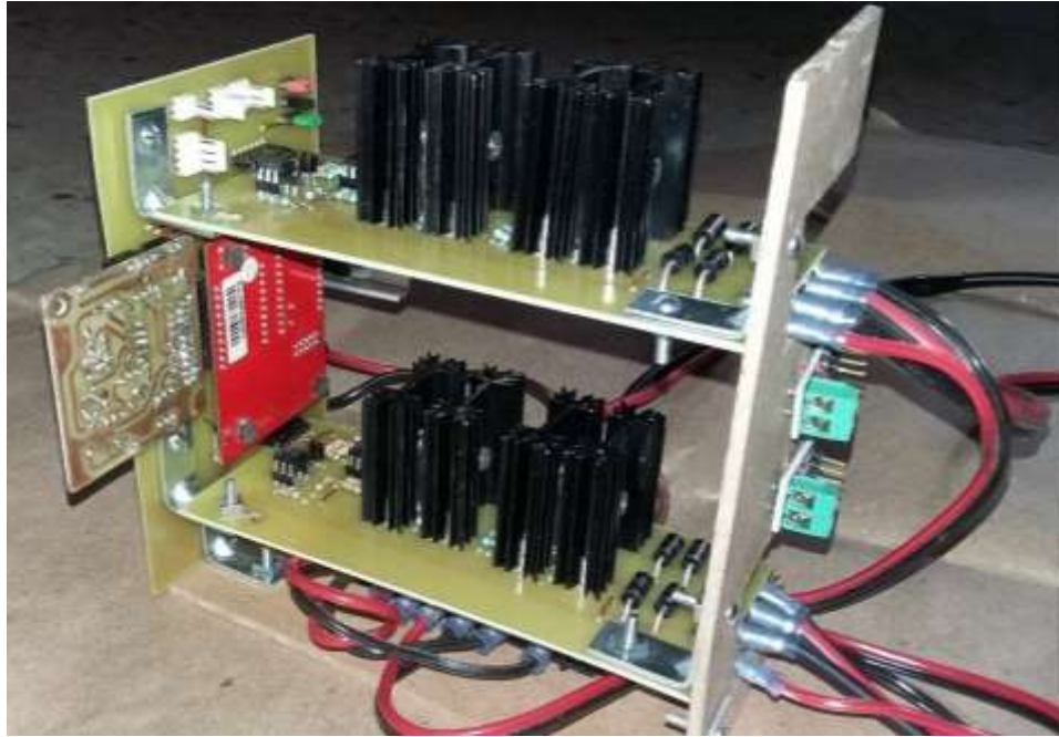
Fotografía 6 Circuito de control ensamblado.
