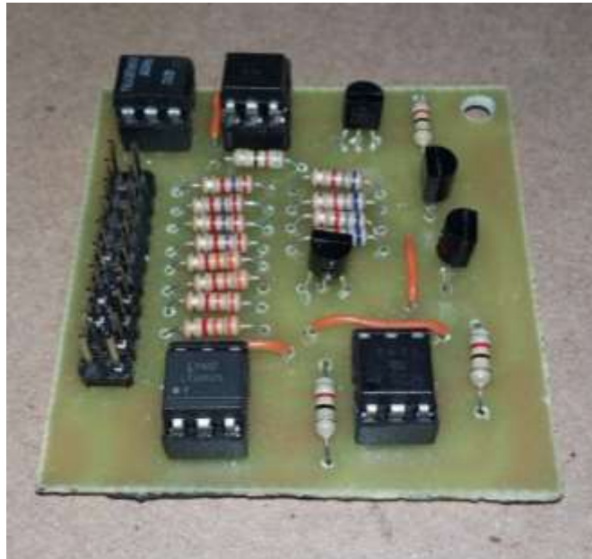
Fotografía 5 Placa para el ajuste del estado de los motores
