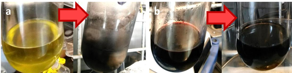
**Figura 7.** Cambios de coloración ocurridos durante la síntesis de nanopartículas de (a) Ni a partir de  $Ni(cod)_2$  y (b) Pd a partir de  $Pd(dba)_2$  en THF, estabilizadas con TDA.
