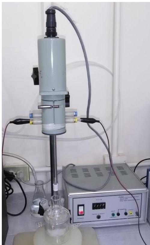
*Figura 9.* Sistema de electrodo de disco-anillo rotatorio, modelo 636 de Princeton Applied Research, empleado para el estudio de la RRO.
