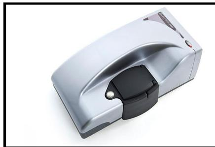
**Figura 2.18. Equipo Zetasiser nano ZSP Malvern utilizado en dispersión de luz dinámica.**
