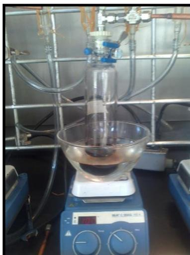
**Figura 2.6. Disolución coloidal de nanoestructuras de Ni estabilizadas con aminas después de 20 horas de reacción.**
