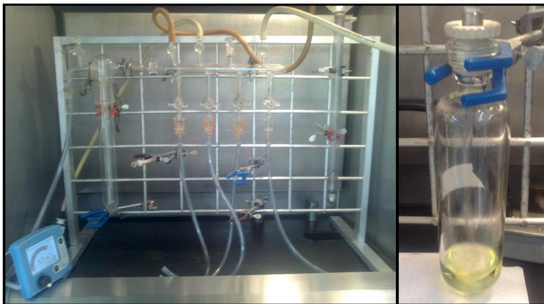
**Figura 2.5. Equipo utilizado en la síntesis, en la izquierda la línea Schlenk y a la derecha el Reactor Fisher-Porter.**
