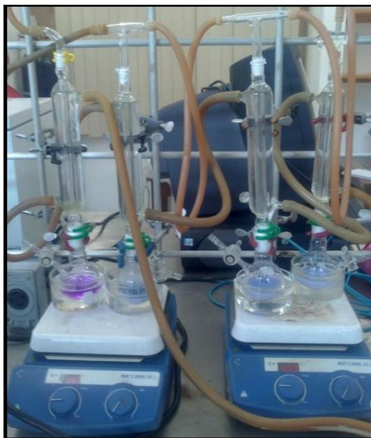
**Figura 2.2. Arreglo experimental de la metodología de síntesis por reducción de sales a partir de NiCl<sub>2</sub> en etanol. .**
