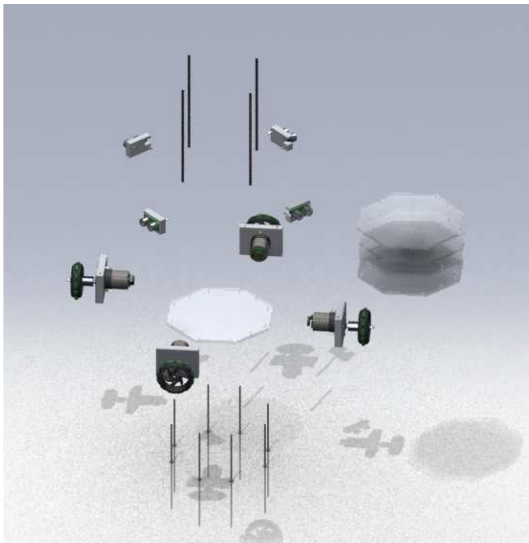
Figura 68 Explosionado del modelo omnidireccional de 4 Ejes.
