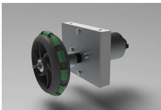
Figura 55 Ensamble de moto reductor, encoder y rueda.
