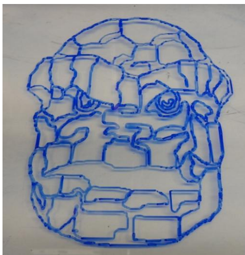
Figura 6.1. Maquinado del rostro del personaje “La Mole”.
