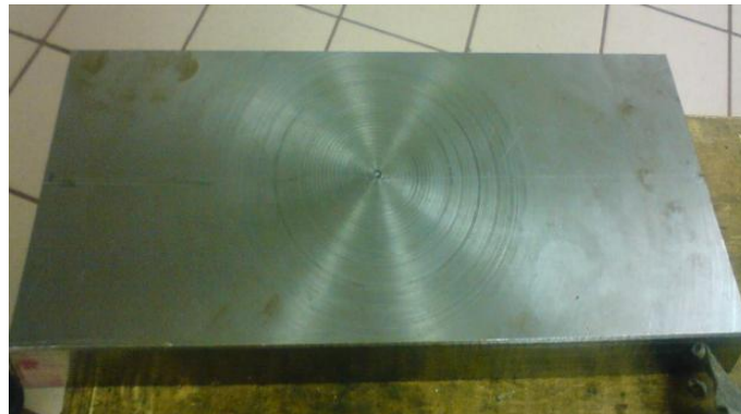
Figura 5.2. Placas de Acero A36 con rectificado burdo.
