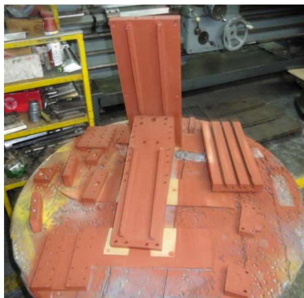
Figura 5.15. Aplicación de Prymer.
