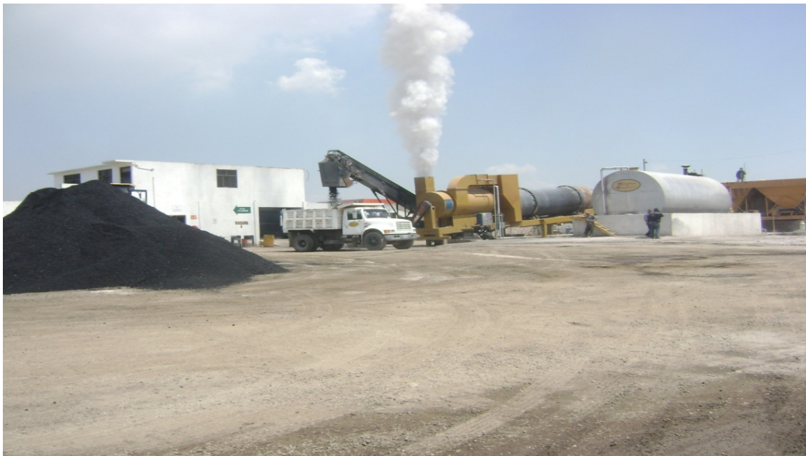
Ilustración No. IV.16. Planta estacionaria para la fabricación de mezclas asfálticas en caliente.
