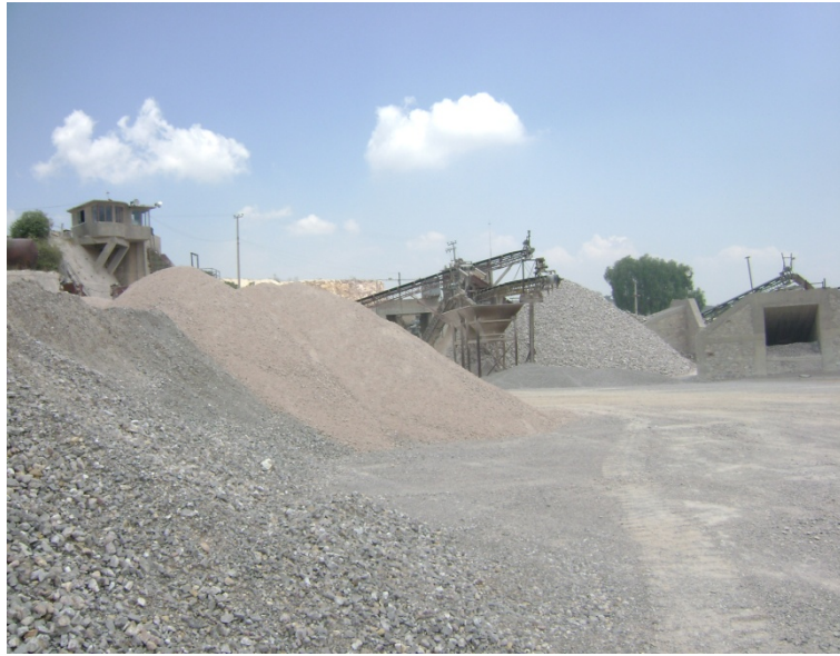
Ilustración No. III.2. Trituración y selección de materiales pétreos para sub-bases, bases y carpetas asfálticas.
