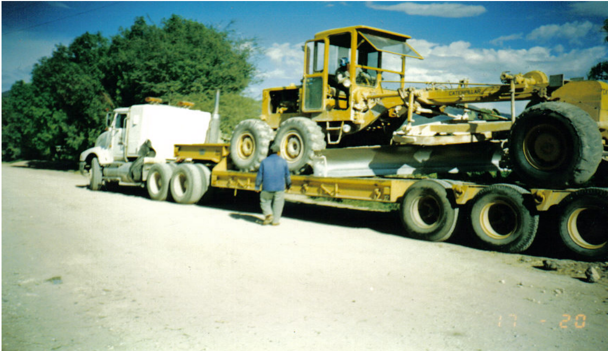
Ilustración No.IV.18. Equipo especializado transportando motoconformadora, utilizada en los procesos constructivos de pavimentos.
