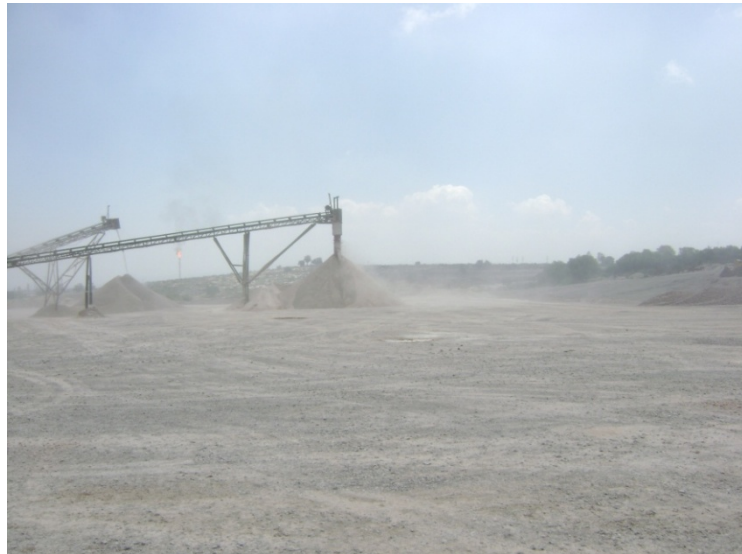
Ilustración No.III.3. Cribado y selección de materiales pétreos (gravas), para capas de sub-base, base y mezclas asfálticas, a través de bandas transportadoras.
