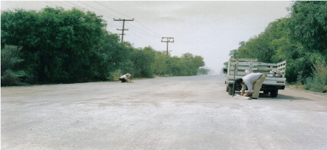
No. VI.29. Laboratorio levantando muestras para compactaciones.
