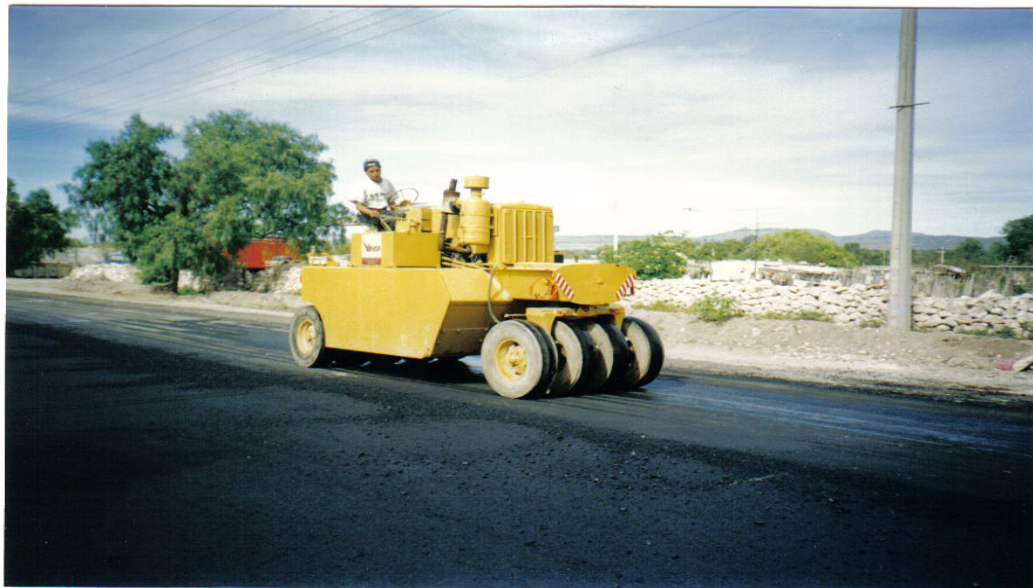
Ilustración No. IV. 9. Compactador neumático para carpetas asfálticas.
