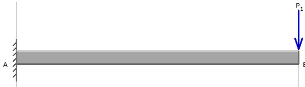
Figura 3.6. modelo de una viga en voladizo
