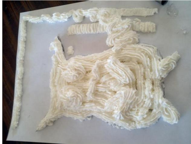
Figura 6.13. Dibujo generado con inyector de prueba.
