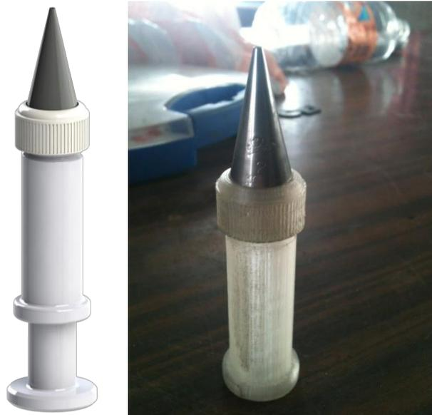
Figura 6.12 Inyector de prueba.
