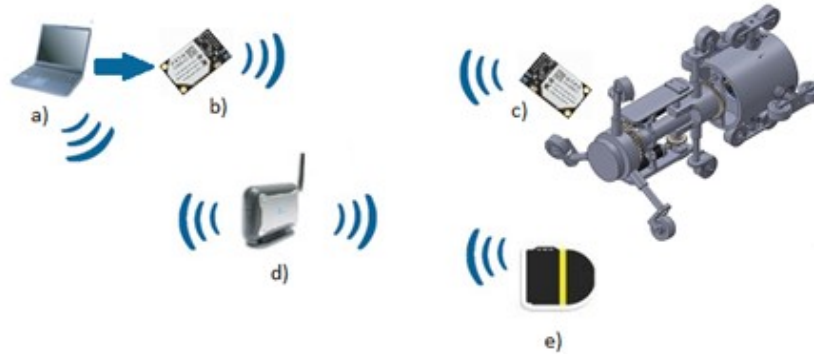
Figura 2.6: Esquema general de comunicación, a) PC, b) Módulo “WIFI/UART” (servidor), c) Módulo “WIFI/UART” (cliente), d) Modem (Repetidor), e) Camara “IP/WIFI”.
