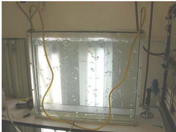
Figura 2. Fotobiorreactor de cara plana tipo air-lift
