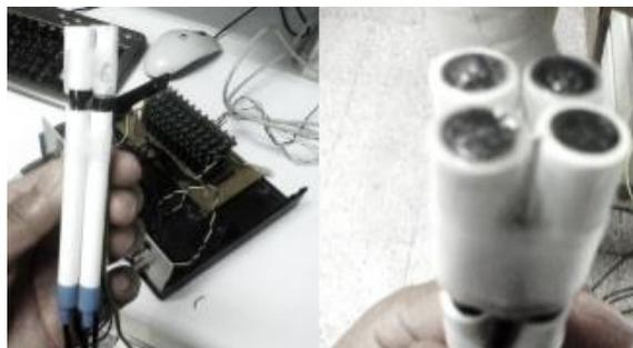
Figura 3.26. Electrodo selectivo a iones.
