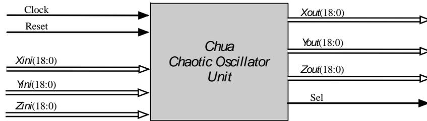
**Figura 4.31.** Unidad de Oscilador Caótico de Chua.
