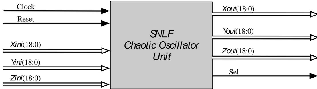
**Figura 4.12.** Unidad Oscilador Caótico de SNLF.
