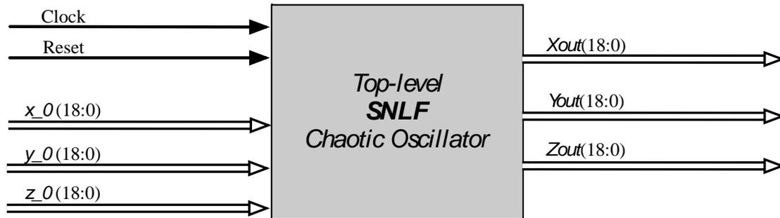
**Figura 4.14.** Top-level de oscilador caótico basado en SNLF.
