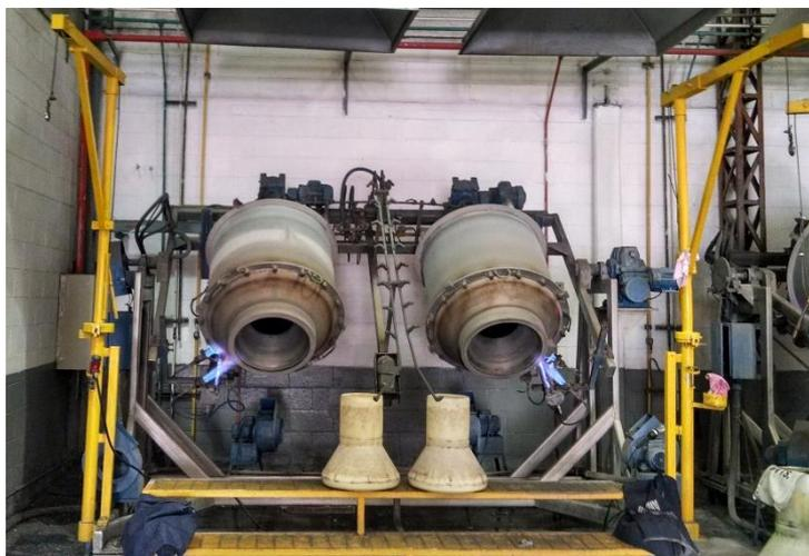
**Figura 9 Máquina de Rotomoldeo – contenedor 450 L.**
